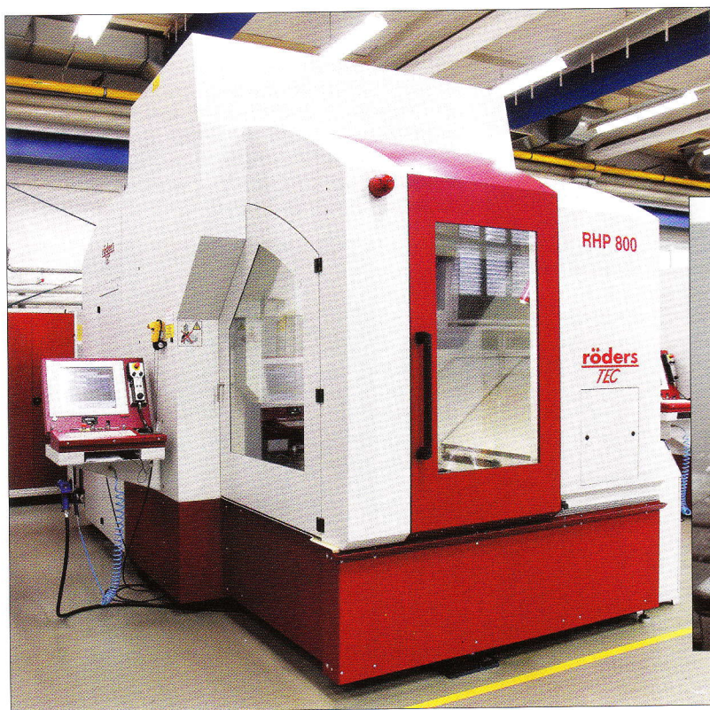
Podstawa hydrostatycznego łoża maszyny. Zmniejszone tarcie ma kluczowe znaczenie w przypadku szlifowania współrzędnościowego – niższy opór tarcia oznacza niższy wydatek energii, mocy i ciepła
