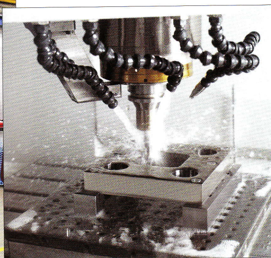
RHP 800 stanowi hydrostatyczną normę najwyższej precyzji firmy Röders
