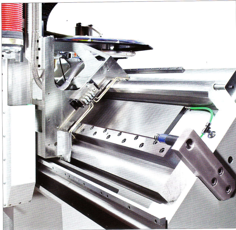
Podstawa hydrostatycznego łoża maszyny. Zmniejszone tarcie ma kluczowe znaczenie w przypadku szlifowania współrzędnościowego – niższy opór tarcia oznacza niższy wydatek energii, mocy i ciepła
